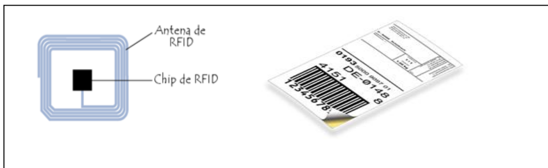
Figura 4. La Imagen de la izquierda corresponde al chip del sistema de radiofrecuencia y la imagen de la derecha a una etiqueta de radiofrecuencia para las gasas 10 .
