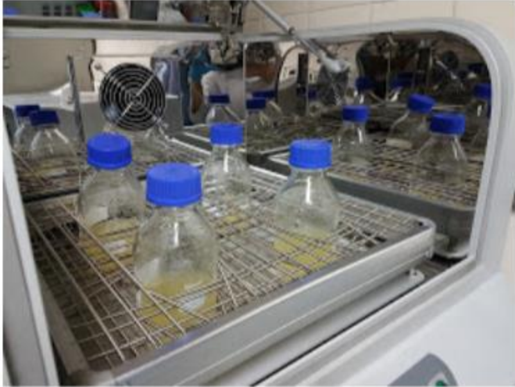
Figura 26: Cultivo. Mecanismo de agitación a 37°
